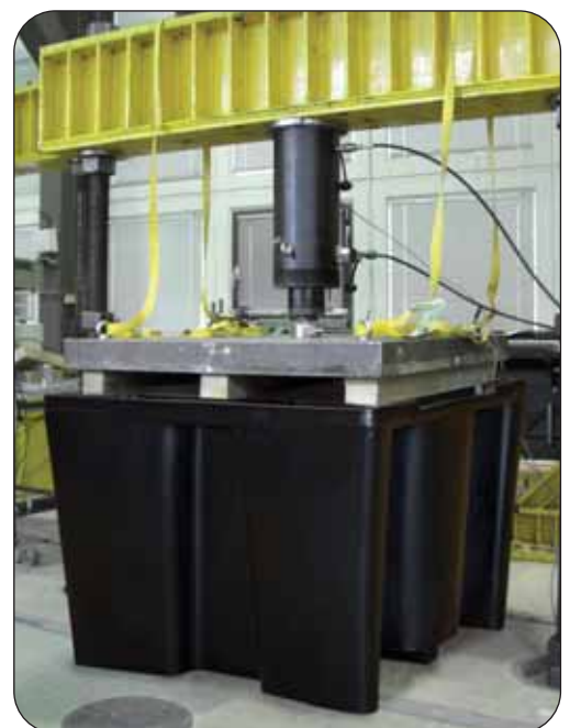
Auffangwanne PE-KT-1 unter einer Prüflast von 8.000 kg
