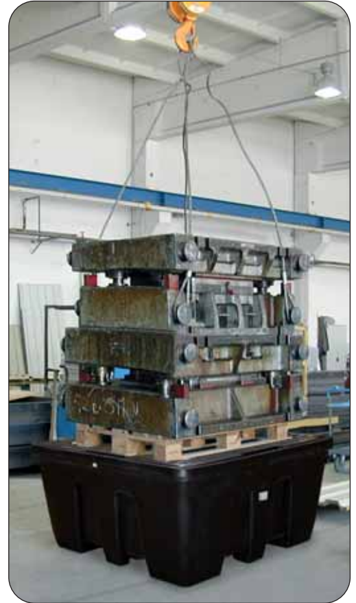
Auffangwanne PE-KT-1S unter einer Prüflast von 8.000 kg
