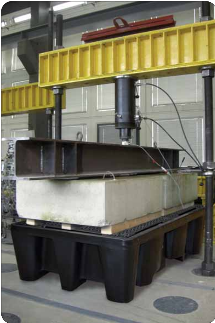
Auffangwanne PE-KT-2 unter einer Prüflast von 16.000 kg
